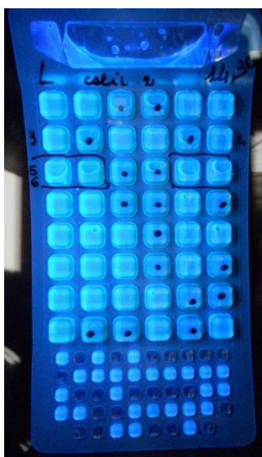
Figura 4: Enterolert dopo incubazione esposto a luce ultravioletta
