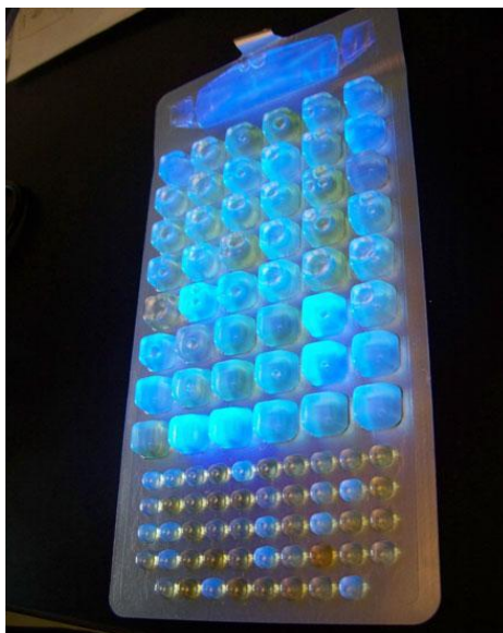
Figura 3: Colilert dopo incubazione esposto a luce ultravioletta
